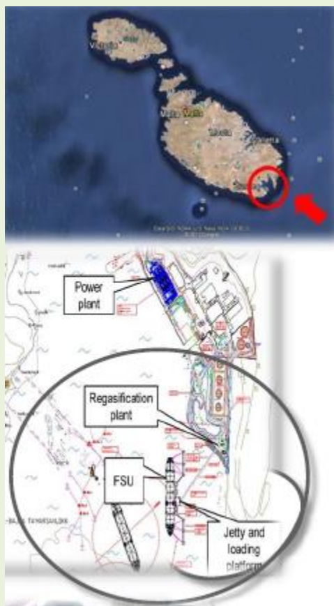
План на FSU, съоръжение за регазификация и централа
